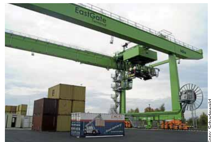
Neue Möglichkeiten: Der mehr als 60 Meter lange Portalkran geht diesen Monat auf dem East-Gate-Terminal in Betrieb.
